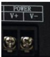
采用带螺丝接线柱
