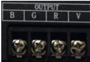
采用带螺丝接线柱
