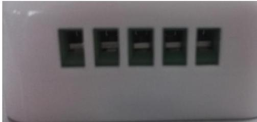
采用带螺丝的对插头作为负载输出接口
